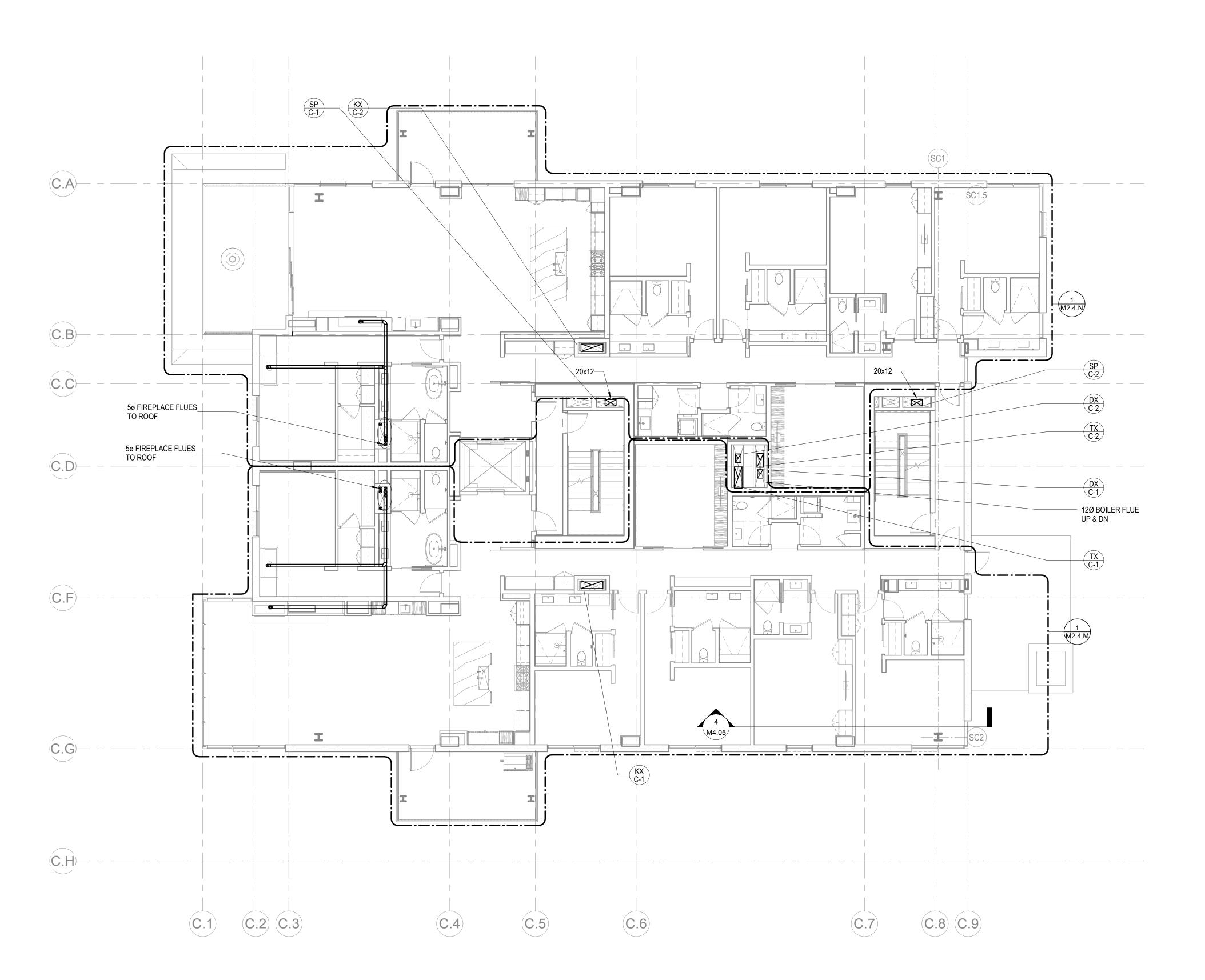
1 TOWER C - LEVEL 3 MECHANICAL DUCT PLAN
