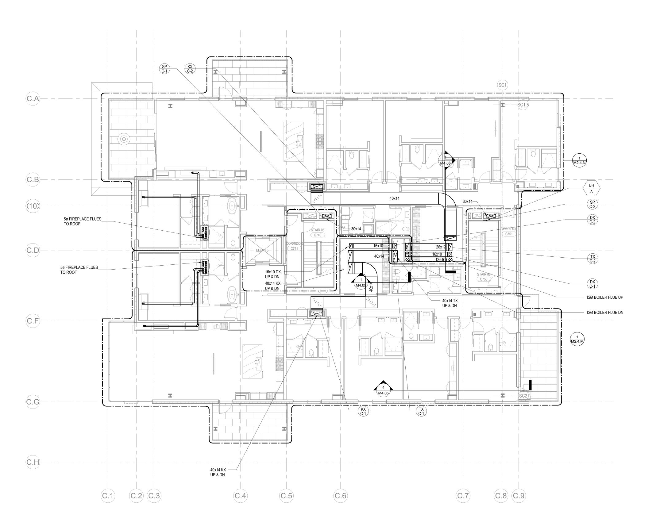
1 TOWER C - LEVEL 7 MECHANICAL DUCT PLAN
