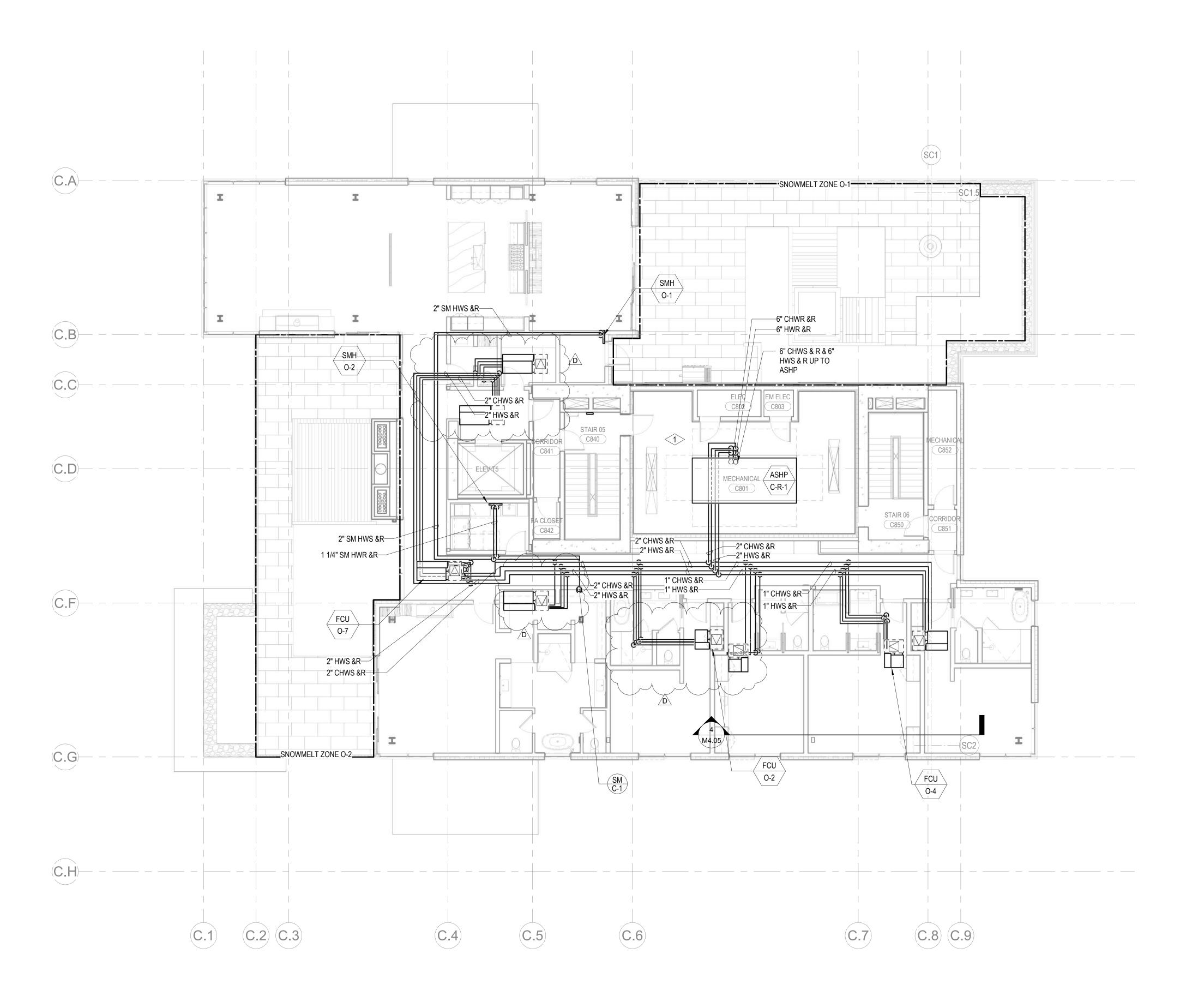
1 TOWER C - LEVEL 8 MECHANICAL PIPING PLAN
