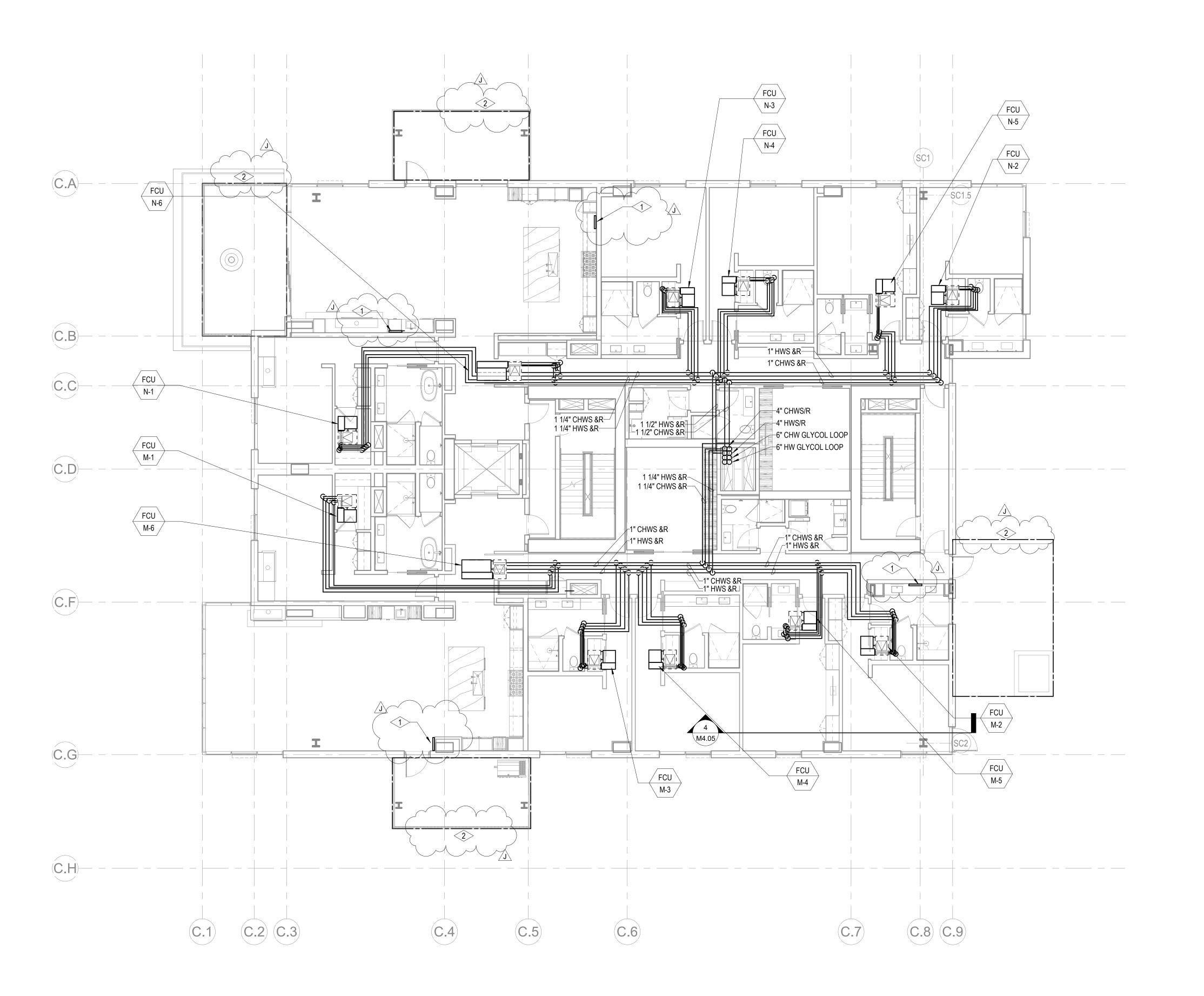
1 TOWER C - LEVEL 3 MECHANICAL PIPING PLAN
