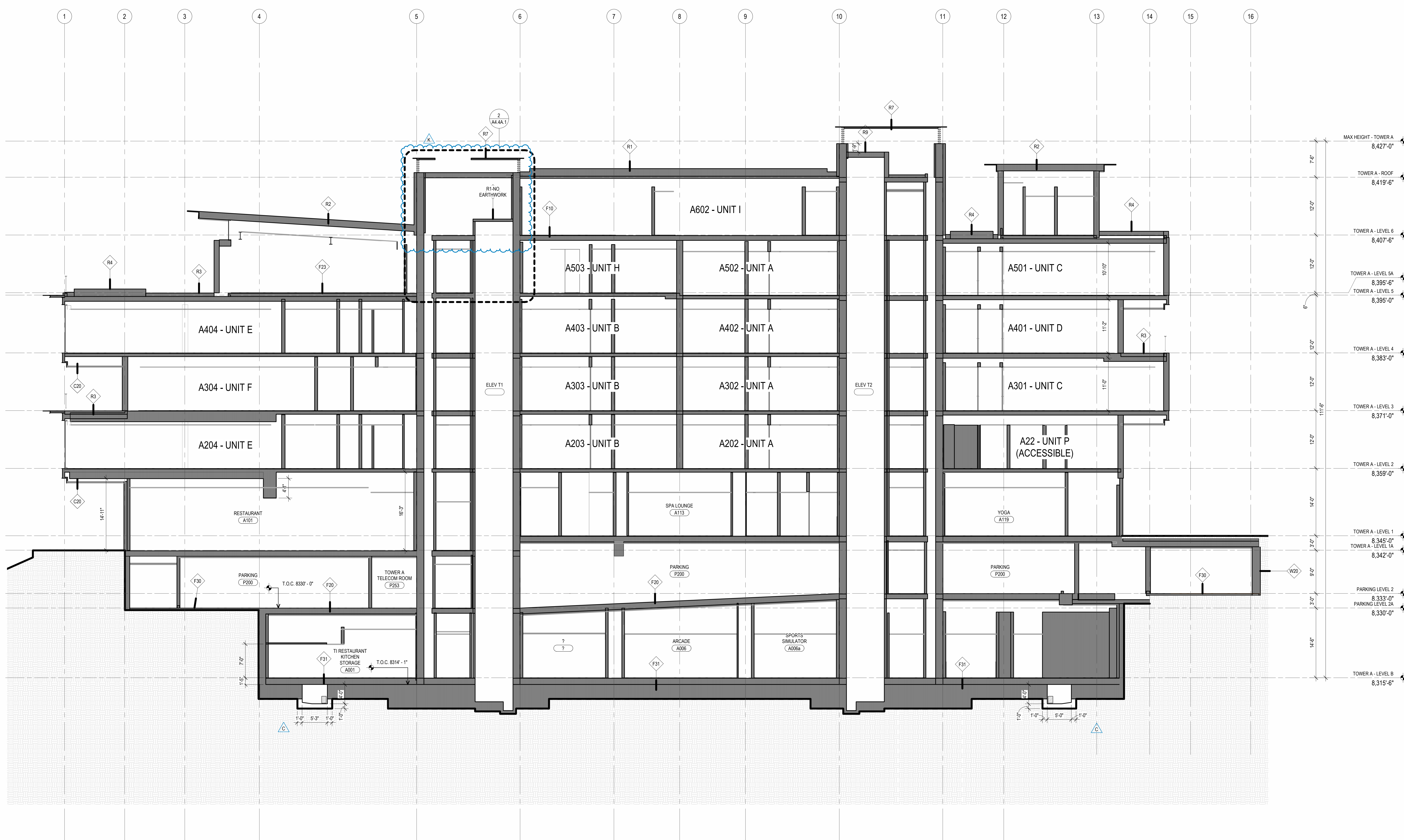
1 SECTION - TOWER A - LONGITUDINAL SCALE: 1/8" = 1'-0"
