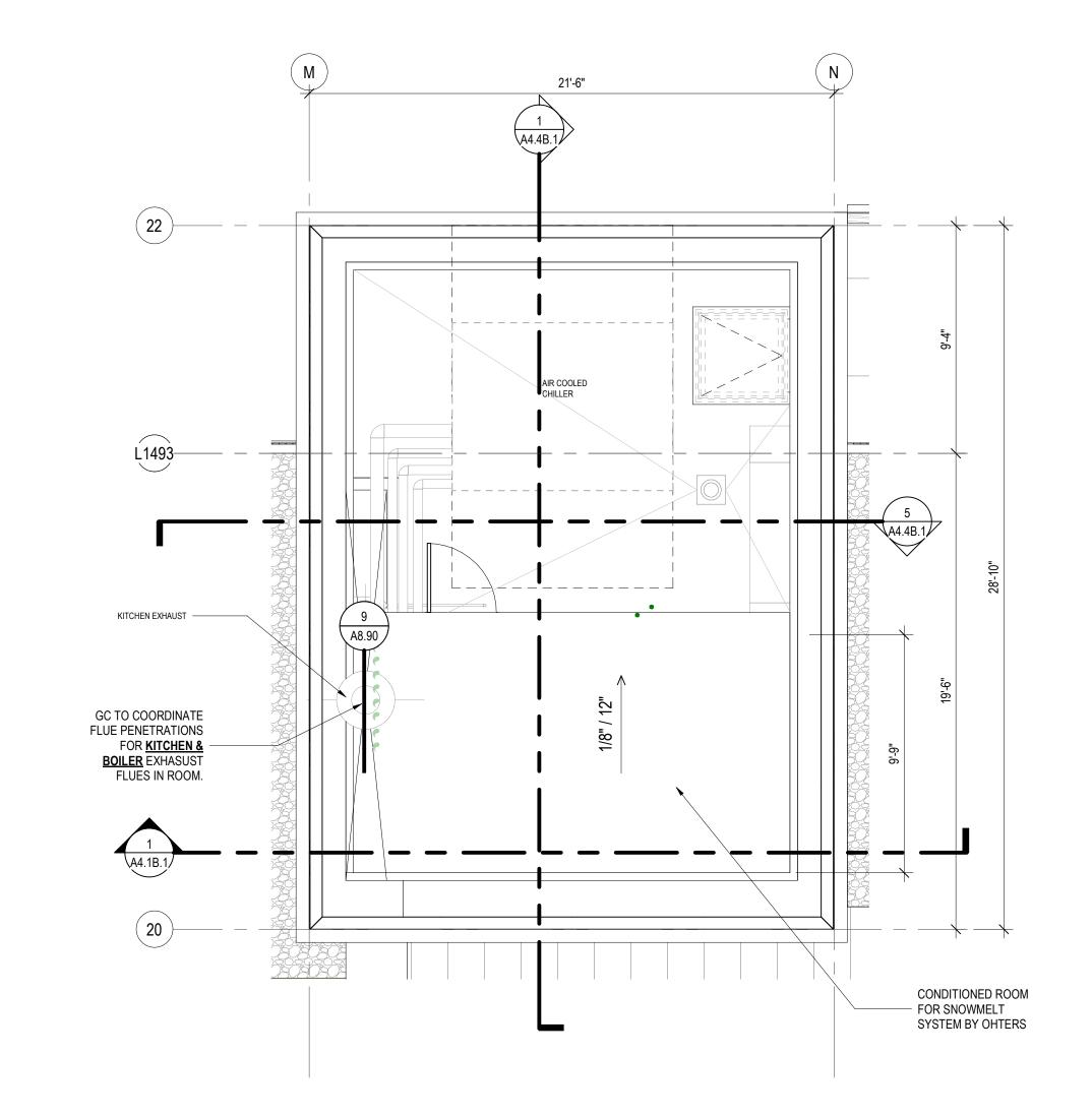
6 TOWER B - ENLARGED PLAN AT MEP PENTHOUSE LEVEL
