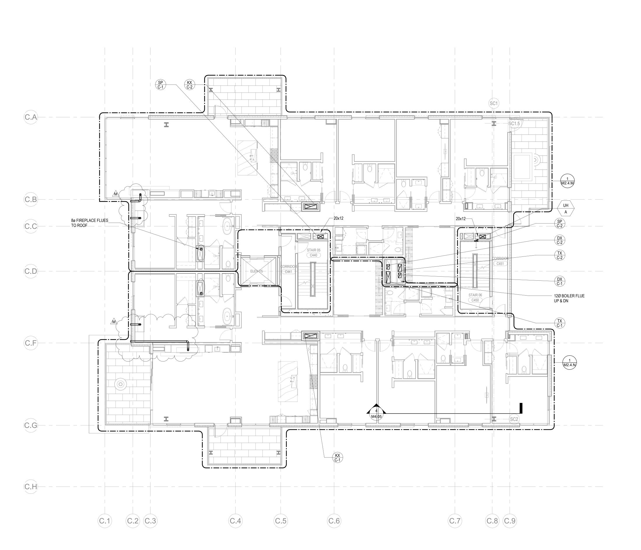
TOWER C - LEVEL 4 MECHANICAL DUCT PLAN
